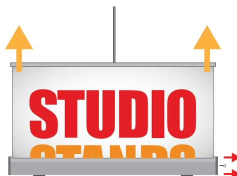
5. Rimuovere la chiavetta di bloccaggio del meccanismo di avvolgimento della stampa quindi sfilare la grafica dalla struttura semplicemente tirando. Fissare l'asta al profilo superiore.
