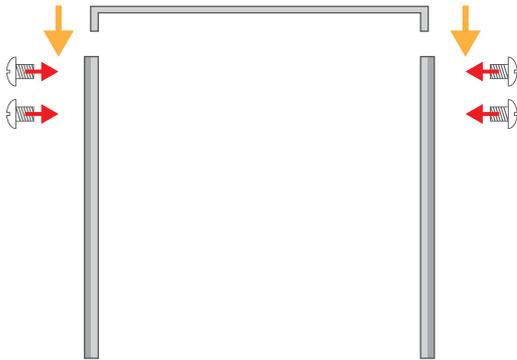
3. Applicare la staffa all'estremità superiore delle spalle e fissare con le viti in dotazione.
