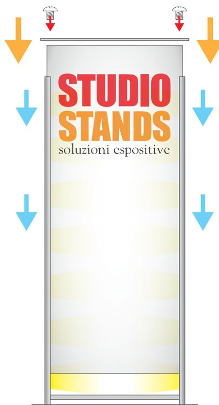
4. Inserire i pannelli stampati nell'apposita sagomatura delle spalle semplicemente a scorrimento. Chiudere la struttura applicando il coperchio e fissare con le viti in dotazione.
