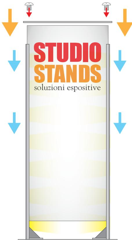
5. Inserire i pannelli stampati nell'apposita sagomatura delle spalle semplicemente a scorrimento. Chiudere la struttura applicando il coperchio e fissare con le viti in dotazione.
