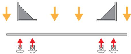
1. Applicare le due angoliere alla piastra ellittica di maggiori dimensioni e fissare con le viti in dotazione.
