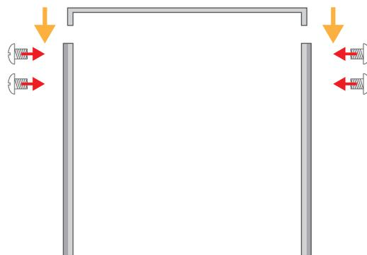
2. Applicare la staffa all'estremità superiore delle spalle e fissare con le viti in dotazione.
