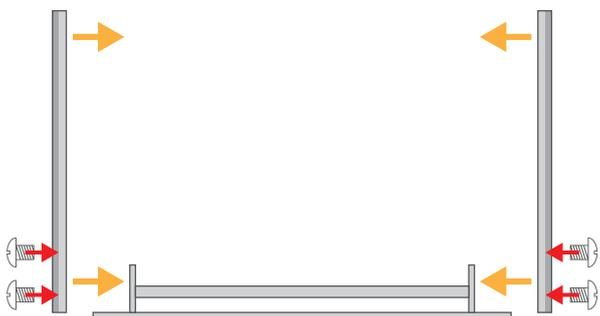
1. Applicare le spalle ai supporti della base e fissare con le viti in dotazione.
