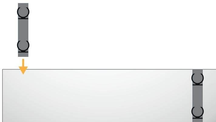
2. Applicare gli attacchi per i tubolari al retro del Crowner con nastro biadesivo e le viti autofilettanti in dotazione.
