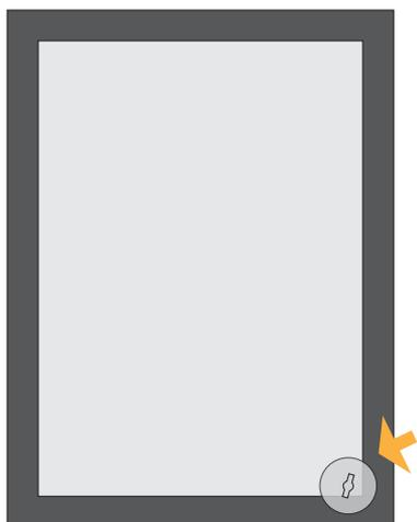
1. Rimuovere il pannello di protezione trasparente utilizzando la ventosa in dotazione.
