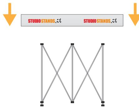
2. Sovrapporre la copertura al telaio e fissare gli angoli con il velcro presente
