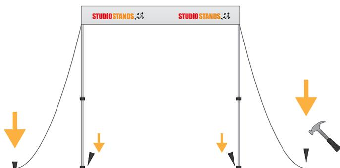
5. Assicurare la copertura e la struttura al terreno con le corde e i picchetti in dotazione
