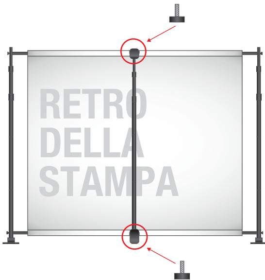
11. Bloccare l'asta stabilizzatrice verticale con le viti corte a farfalla in dotazione nella parte posteriore della stampa
