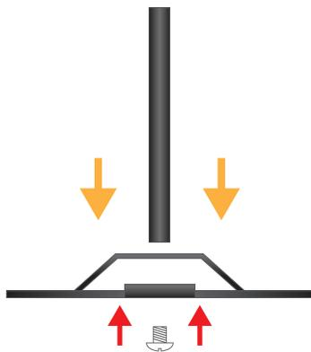
7. Inserire l'asta verticale telescopica negli appositi fori presenti nel piedistallo e bloccare con la vite in dotazione (configurazione minima)
