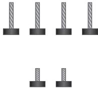
1. Il Kit comprende nr.4 viti lunghe da utilizzare per il fissaggio delle aste orizzontali e nr. 2 viti corte per il fissaggio dell'asta stabilizzatrice centrale (necessaria solo per formati extra large)
