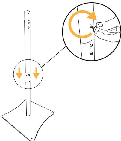
3. Inserire il segmento centrale e bloccare in posizione agendo sulla vite farfallata per bloccare in posizione
