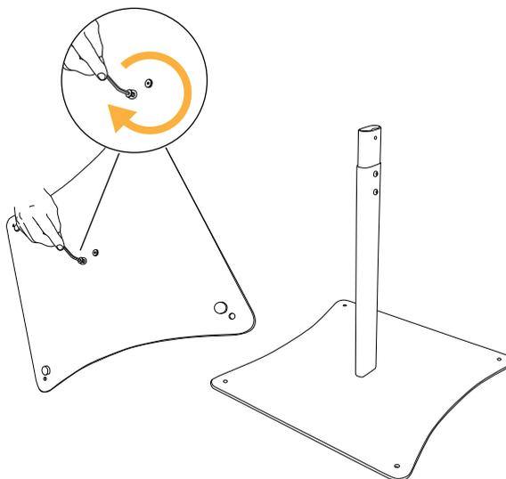
2. Inserire le viti, applicare il primo segmento di colonna e agire con brugola sulle viti per bloccare in posizione
