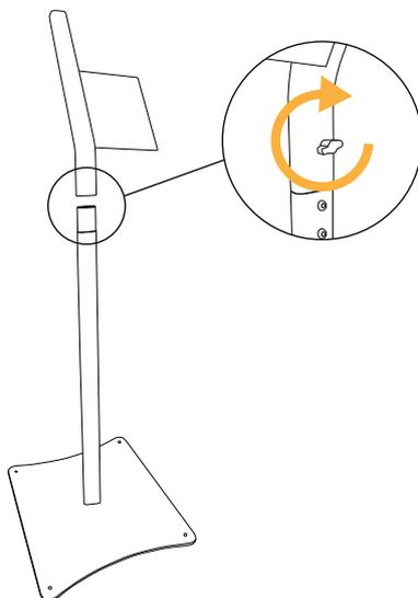
4. Applicare la parte terminale della colonnina e bloccare in posizione agendo sulla vite farfallata
