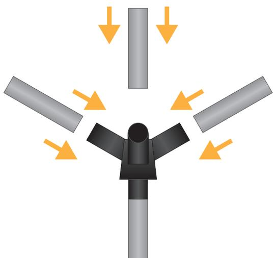
1. Inserire le aste di supporto negli appositi alloggi del profilo in plastica del tubolare.
