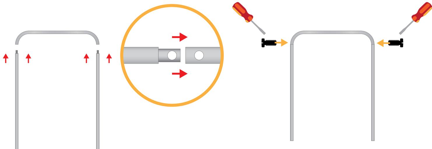
1. unire l'asta curva con le 2 aste verticali e bloccare con le viti in dotazione
