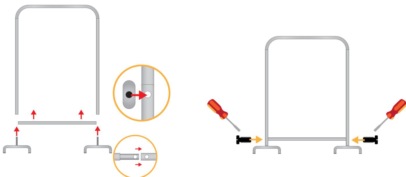
2. inserire il perno dei piedini nelle aste verticali, posizionare l'asta orizzontale e bloccare con le viti in dotazione
