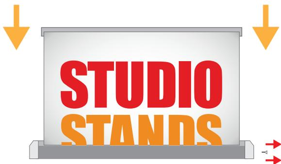
**3. Rimuovere la chiave di bloccaggio del meccanismo di avvolgimento della stampa quindi riavvolgere la grafica all'interno della struttura.**
