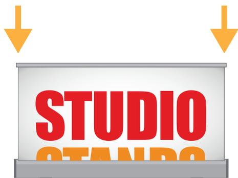
**3. Rimuovere la chiave di bloccaggio del meccanismo di avvolgimento della stampa quindi riavvolgere la grafica all'interno della struttura.**
