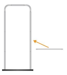
**4.** Avvitare il traversino intermedio per garantire una maggiore consistenza alla struttura
