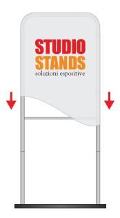
5. Inserire la stampa sulla struttura e tirare verso il basso fino a tensionamento completato
