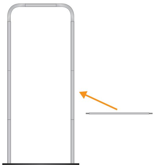
4. Avvitare il traversino intermedio per garantire una maggiore consistenza alla struttura
