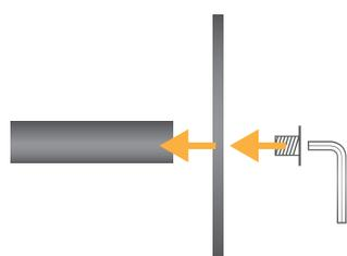
1. Unire la base circolare al palo verticale fissando le parti con la vite e la brugola in dotazione.
