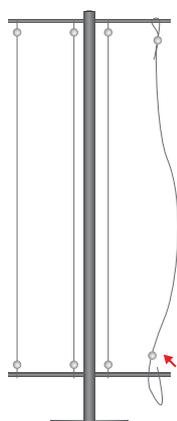
4. Tensionare i cavi d'acciaio verso il basso e ricreare il cappio mediante l'accessorio a sfera in dotazione
