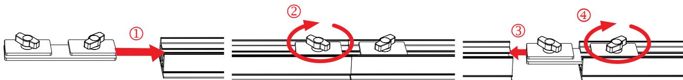
4 Collegare la sezione orizzontale a una delle 2 sezioni verticali utilizzando il connettore toolless a 90°
