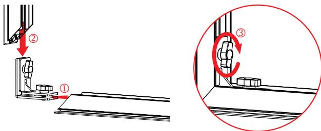
5 Chiudere tutti i punti di connessione e fissare la sezione orizzontale inferiore alla base
