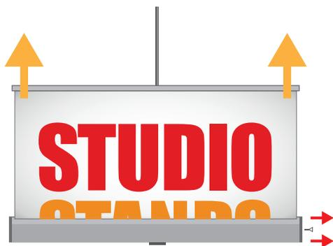
5. Rimuovere la chiavetta di bloccaggio del meccanismo di avvolgimento della stampa quindi sfilare la grafica dalla struttura semplicemente tirando.
