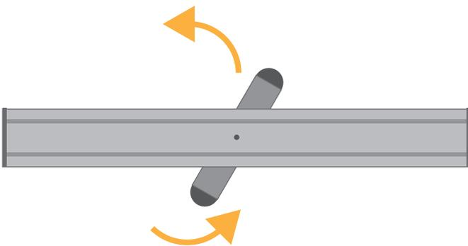
3. Ruotare il piedino presente nella parte inferiore dell'espositore in posizione perpendicolare rispetto alla struttura.
