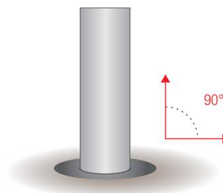
4. Prima che il cemento solidifichi verificare la verticalità con l'ausilio di una bolla e la prima sezione del palo del pennone
