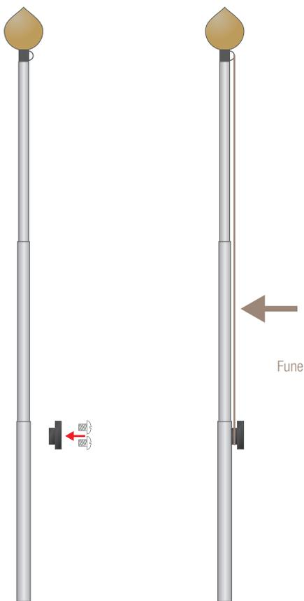
**7.** Introdurre la fune quindi fissare la galloccia con le vite autofiletanti fornite nella parte bassa del pennone
