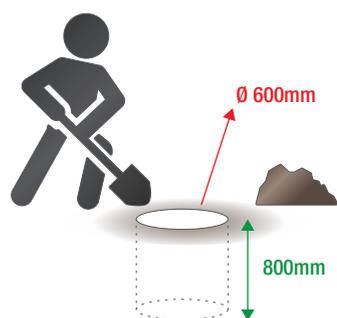
1. Scavare un buco diametro 600mm con profondità 800mm
