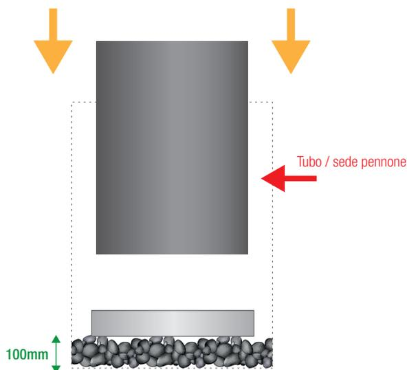
2. Posizionare sul fondo del foro praticato nel terreno 100mm circa di ghiaietto per il drenaggio dell'acqua. Posizionare il pennone all'interno di un tubo avente diametro idoneo ad ospitare il palo.
