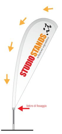
**3.** Inserire la struttura nell'asola della stampa e fissare con le fettucce in velcro
