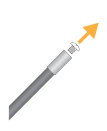
**2.** Rimuovere la vite nella parte inferiore dell'asta telescopica.
