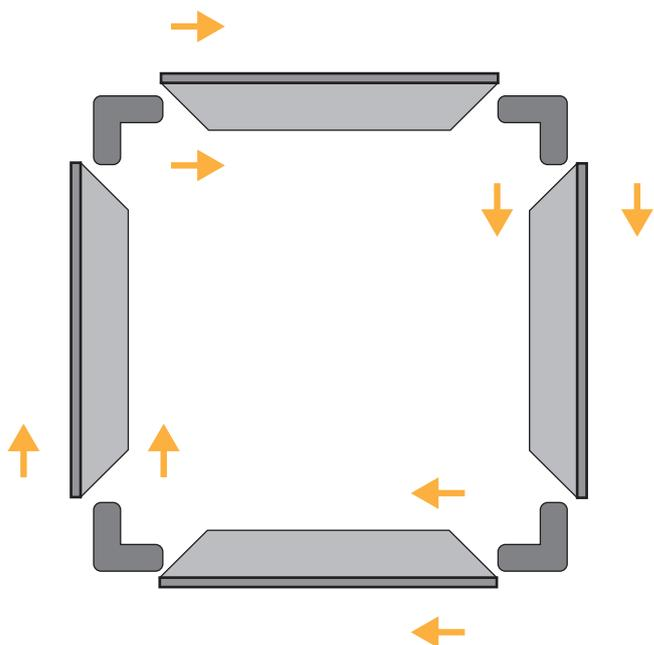
1. Inserire i raccordi ad incastro nelle componenti a formare la cornice
