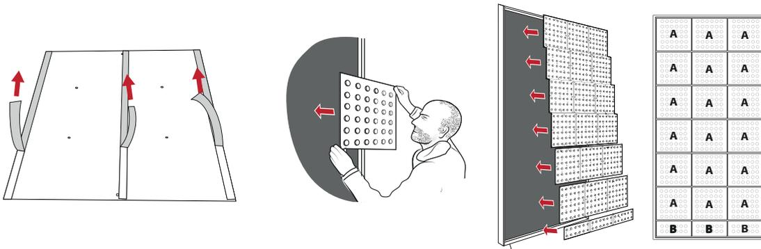
3. Applicare i moduli per la retroilluminazione LED al pannello tramite il biadesivo presente sul retro dei moduli
