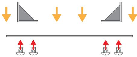
1. Applicare le due angoliere alla piastra ellittica di maggiori dimensioni e fissare con le viti in dotazione.
