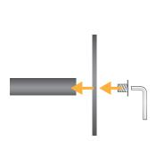
**1.** Unire la base circolare al palo verticale fissando le parti con la vite e la brugola in dotazione.
